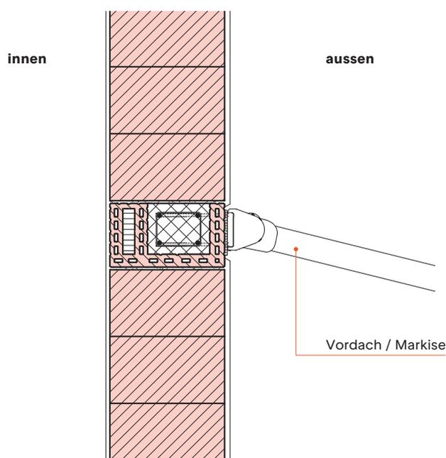
Verankerung des Vordaches / Markise muss durch Ingenieur oder Hersteller Vordach / Markise nachgewiesen werden
