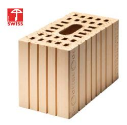
Backstein für Einsteinmauerwerk, mechanische Eigenschaften gemäss Deklaration, erhöhte Festigkeiten (vgl. SIA-Norm 266). Die Backsteine Sumo und Seismo können problemlos im SwissModul-Mauerwerk eingebunden werden, vermeiden Mischbauweisen und können Beton-Wandteile ersetzen.
