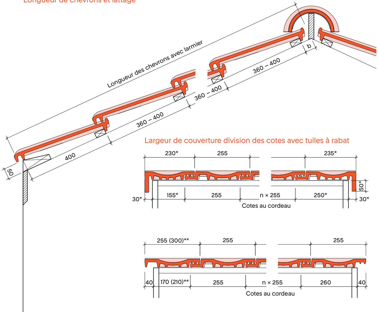
\* Mesure utile à la tête de tuile    \*\* Même cote pour la tuile normale
