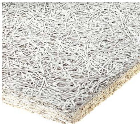
Heradesign est un panneau acoustique monocouche en laine de bois liée à la magnésie offrant différentes finitions de surface. Recommandé en termes de biologie de la construction. Il est idéal pour des faux-plafonds et des revêtements de mur décoratifs et acoustiques. Pour une utilisation en intérieur et dans des zones extérieures sous abri, non exposées aux influences directes des intempéries telles que pluies ou polluants.
