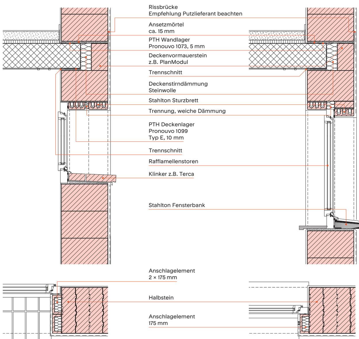
Diese Konstruktionsdetails können umsetzbar sein bei kleineren Fenstergrößen. Dies muss zwingend vorab geprüft werden.
